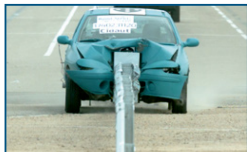
Ensaio TT.1.2.100 Carro de 1.300 kg a 100 km/h e 0° (Frontal centralizado)
